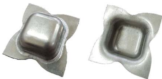
شکل ۶) قطعه با سطح مقطع مربعی شکل‌داده‌شده با فرآیند کشش عمیق به‌کمک الکتریسته در جریان ۵۰۰ آمپر و عمق کشش ۱۷ میلی‌متر
