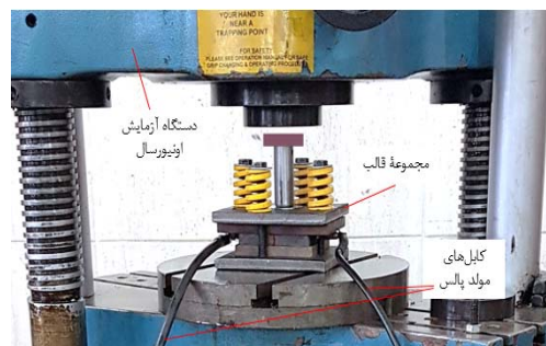
شکل ۴) نمای مجموعه قالب عایق‌شده بر روی میز دستگاه آزمایش اونیورسال
