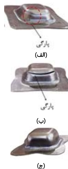
شکل (۷) نمونه های کشیده شده با ورق به ابعاد ۶۵×۶۵ میلی متر در حالت: (الف) بدون جریان با پارگی، (ب) شکل موج مربعی با پارگی، (ج) شکل موج سینوسی بدون پارگی
