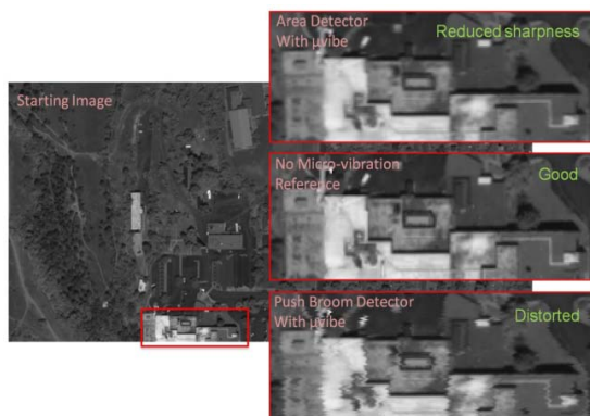
شکل ۲) تصویر شبیه‌سازی شده از تاثیرات ریزاغتاشات بر روی انواع مختلف آشکارسازها [2]
