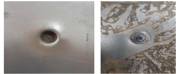
شکل ۳) جوش کاری دو ورق فولادی با پرتابه کروی (ضخامت صفحه پرنده ۳ و فاصله بین دو ورق ۱/۰ میلی‌متر)
