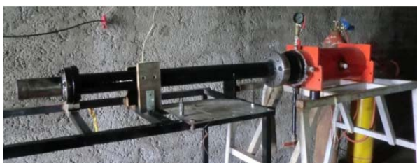
شکل ۱) سامانه انفجار مخلوط گازها
