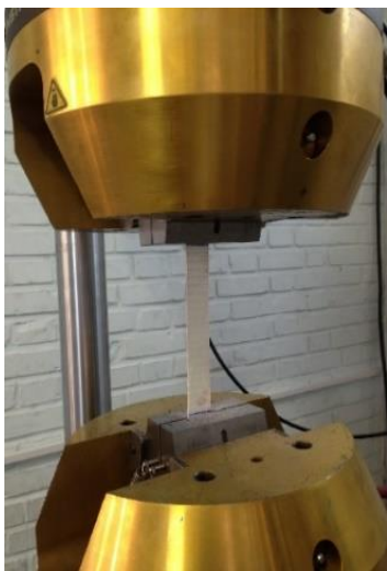
شکل ۶) نمونه آزمون کشش کامپوزیتی اپوکسی/الیاف شیشه تحت بارگذاری
