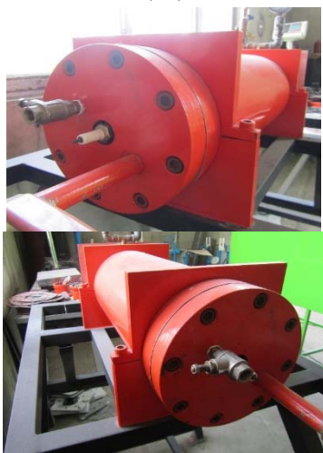
شکل ۱) سامانه انفجار مخلوط گازها در دانشگاه گیلان؛ (الف) شماتیک، (ب) واقعی
