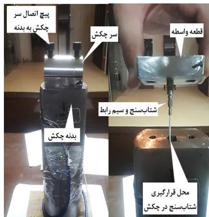
شکل ۸) نحوه نصب شتاب سنج روی چکش با استفاده از قطعه واسطه
