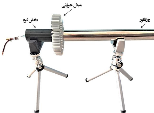
شکل ۱۲) ساختار موتور گرماصوتی موج ایستا با آرایش صفحات موازی در استک
