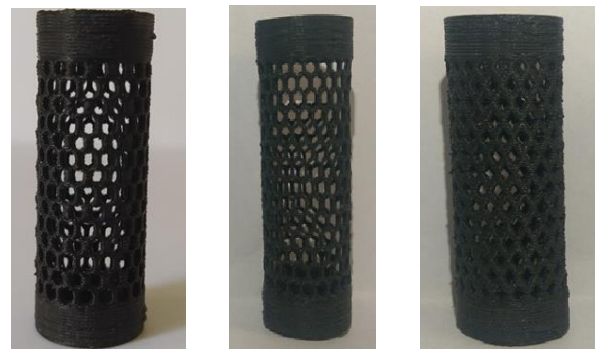
شکل ۷ استنت چاپ شده، (الف) مشبک لوزی شکل (ب) مشبک لانه‌زنبوری (ج) مشبک بیضی شکل
