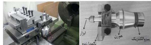
شکل ۳) ابزار کوبش فراصوتی و نگاه‌دارنده (ب) نگاه‌دارنده و اتصال ابزار کوبش فراصوتی روی دستگاه
