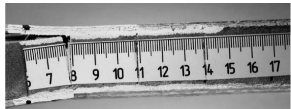
شکل ۶) رشد ترک در فوم و شکست بلوک اول فوم و متناظر با ناحیه (۳) تا (۴) در منحنی بار-جابجایی
