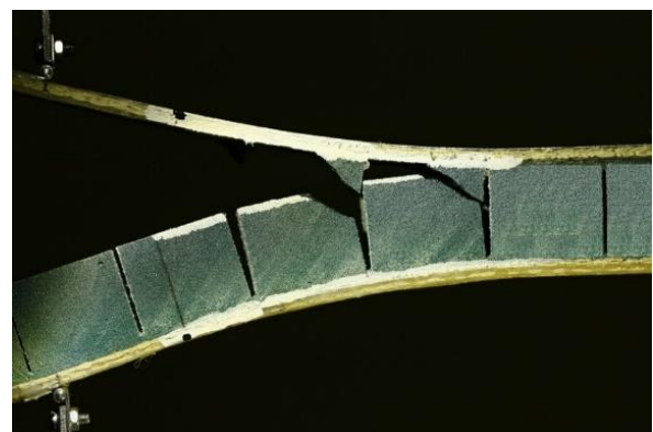
شکل ۸) شکست نهایی بلوک سوم فوم- متناظر با ناحیه (۶) تا (۷) در منحنی بار-جابجایی
