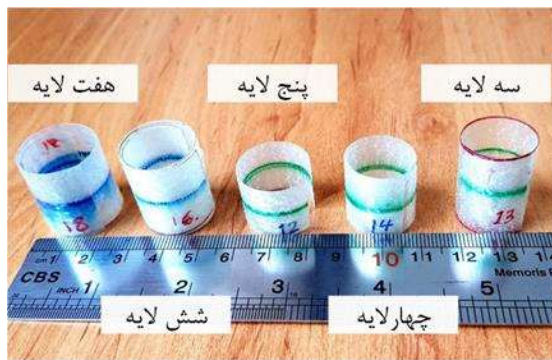
شکل ۱۲ نوارهای دوپایدار (BiTS) با لایه‌چینی مختلف، پیچیده شده (در حالت تعادل دوم)
