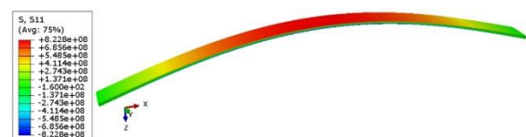
شکل ۲) توزیع تنش کششی در خمش دو نقطه‌ای.
