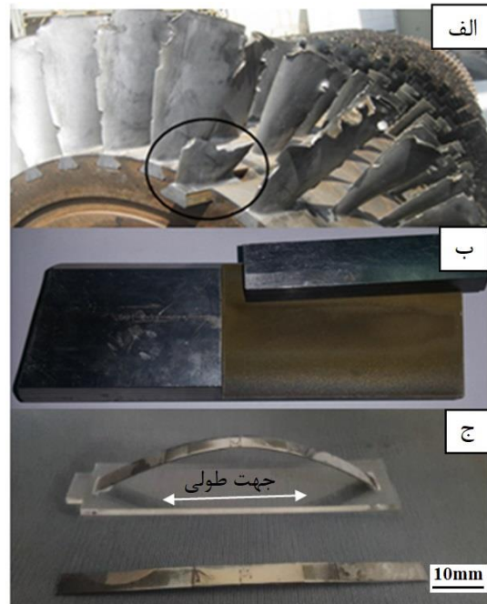
شکل ۱ (الف) پره‌ی شکسته شده، (ب) برشی از پره، (ج) نمونه‌ی تنش‌دار و بدون تنش.
