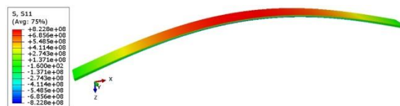
شکل ۲) توزیع تنش کششی در خمش دو نقطه‌ای.
