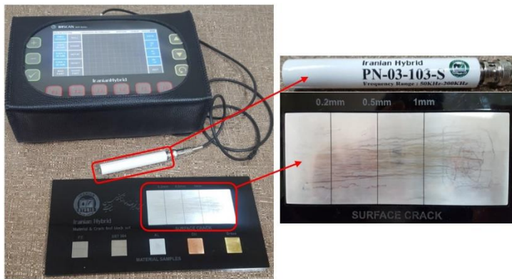
شکل ۸) شماییک دستگاه ادی کارنت و صفحه‌ی کالیبراسیون.
