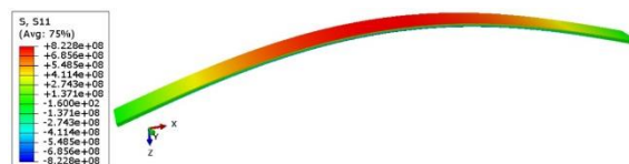
شکل ۲) توزیع تنش کششی در خمش دو نقطه‌ای.
