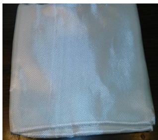
شکل ۱) پارچه از جنس شیشه E-Glass و محلول تفلون با درصد وزنی ۶۰ درصد.
