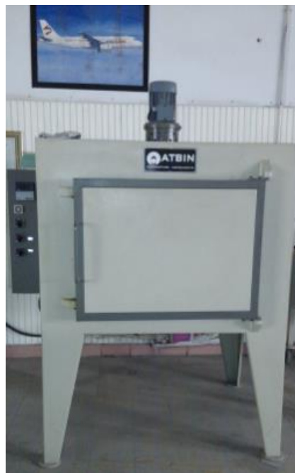
شکل ۲) کوره عملیات حرارتی آتیین.
