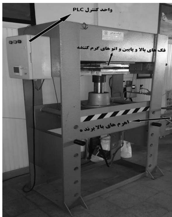
شکل ۳) دستگاه پرس گرم با واحد کنترل کنتراول PLC و تشریح قسمت‌های آن.
