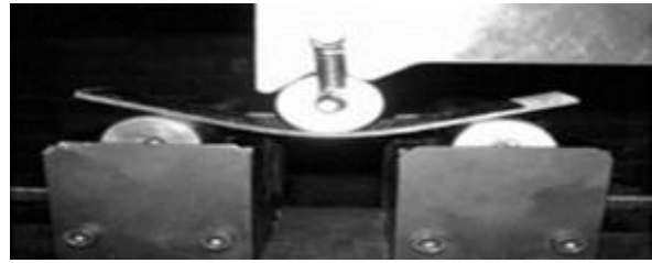
شکل ۶) نمونه کامپوزیتی ساخته شده تحت آزمون خمش
