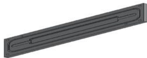
شکل ۱) کفه پایینی قالب RTM
