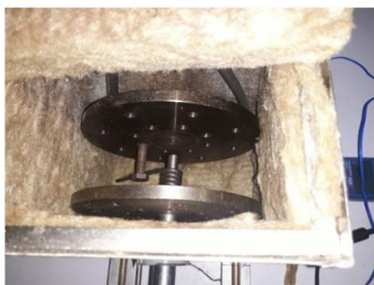
شکل ۶) نمای داخل کوره و عایق بندی آن
