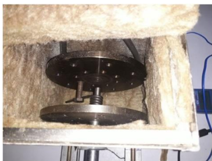
شکل ۶) نمای داخل کوره و عایق بندی آن
