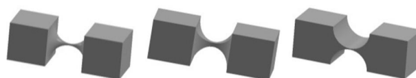
شکل 3 مفصل‌های خمشی یک، دو و سه درجه آزادی (الف) لولایی [9] (ب) یونیورسال [10] (ج) کروی [9]
