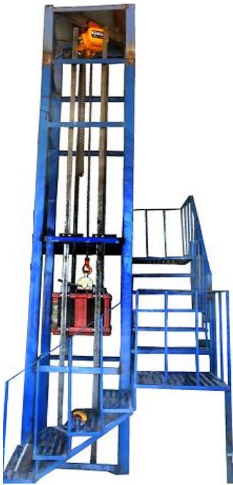
شکل ۱) سامانه سقوط وزنه با ظرفیت پایین در آزمایشگاه ضربه و انفجار در دانشگاه گیلان
