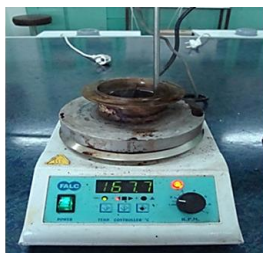
اندازه‌گیری نقطه‌ی اشتعال به روش فنجان باز
