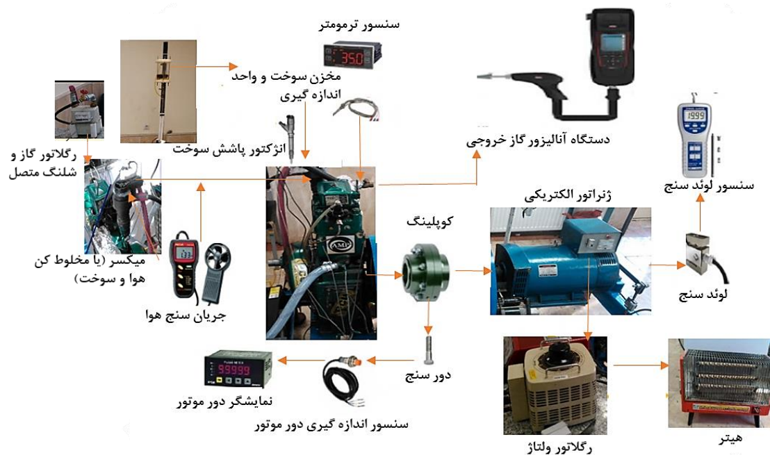
شکل ۵) تجهیزات آزمایش و موتور دیزلی
