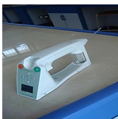
دستگاه چگالی سنج دیجیتال مدل DA-130N
