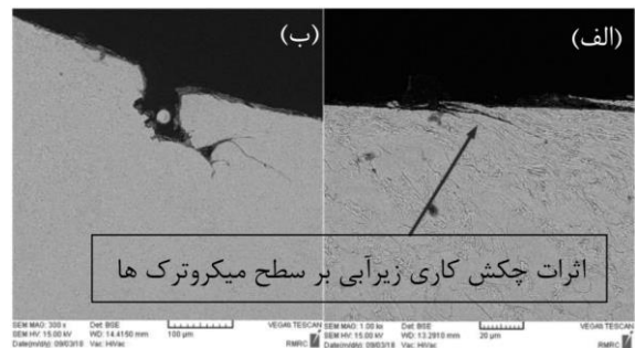
شکل ۱۰) (الف) تصاویر تأثیر چکش کاری در زیر آب بر روی ترک سطحی
