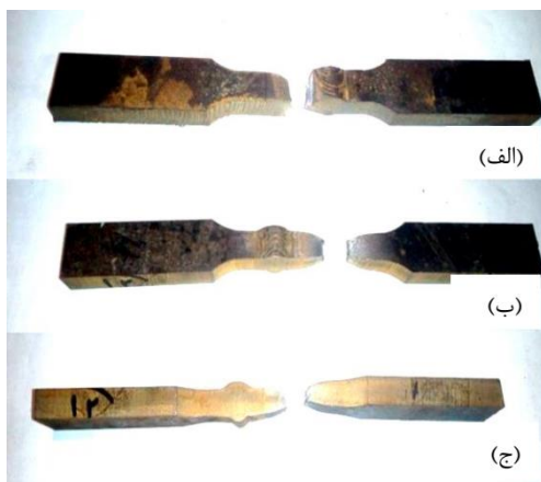
شکل ۶ الف- مقطع شکست در قطعه بدون چکش‌کاری ب- مقطع شکست در قطعه با چکش‌کاری در هوا ج- مقطع شکست در قطعه با چکش‌کاری در زیر آب
