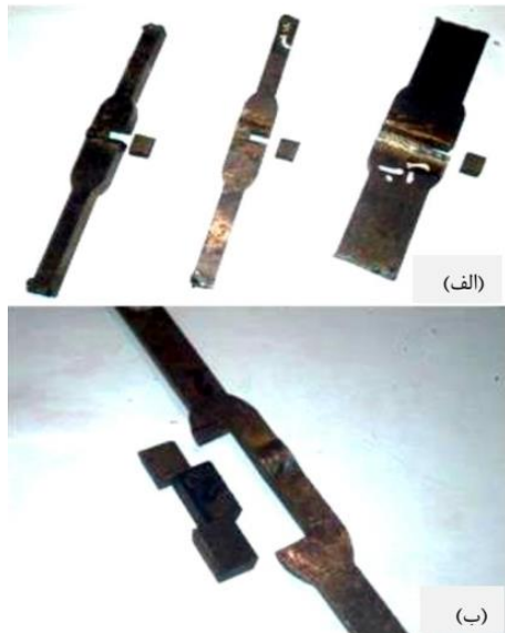
شکل ۳ الف- نمونه‌های برش کاری توسط وایبرکات برای متالوگرافی ب- نمونه‌های برش کاری شده توسط وایبرکات برای آزمون ریزسختی سنجی
