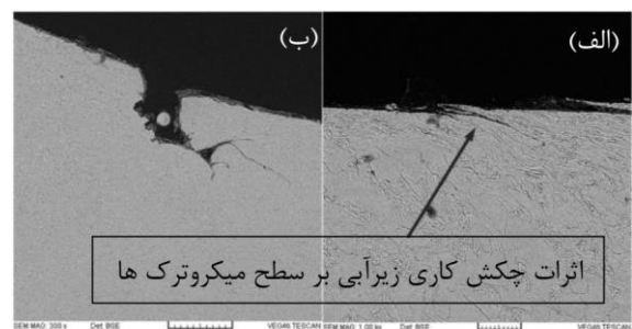
شکل ۱۰) (الف) تصاویر تأثیر چکش کاری در زیر آب بر روی ترک سطحی
