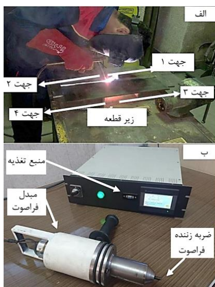
شکل ۱ (الف) روش و ترتیب جوشکاری روی ورق فولادی انتخاب شده. (ب) - چیدمان و تجهیزات عملیات چکش‌کاری فراصوتی
