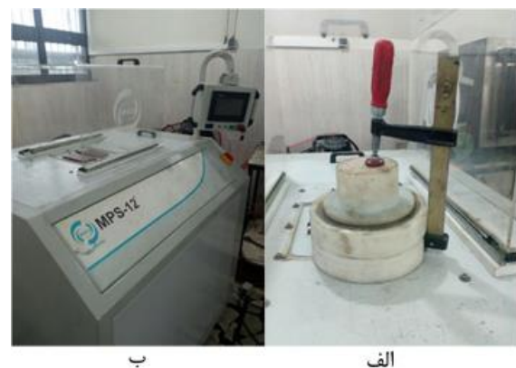
شکل ۴) الف) سیم‌پیچ و قالب مخروطی در بالای آن که توسط پیچ‌دستی به هم محکم شده‌اند. ب) دستگاه مورد استفاده برای انجام آزمون تجربی
