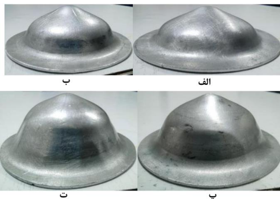
شکل ۲۳) تصویر قطعات شکل‌دهی شده توسط سیم‌پیچ جدید. الف) ۷ و ۳۰۰۰ (ب) ۳۴۰۰، ۳۴۰۰ (پ) ۳۷۰۰، ۴۰۰۰ (ت) ۴۰۰۰
