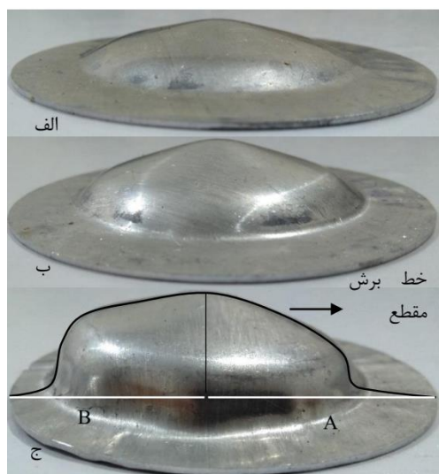
شکل ۸) تصاویر قطعات شکل‌دهی شده در ولتاژهای الف) ۴kV، ب) ۵kV، ج) ۶kV
