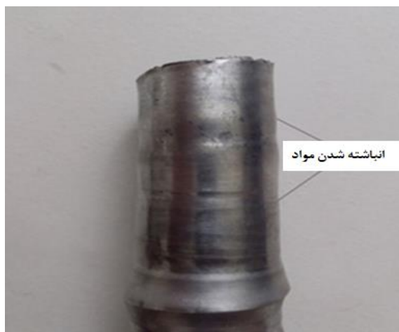
شکل ۵) غیریکنواختی شدید و رشد قطری لوله به دلیل افزایش درصد کاهش ضخامت و کافی نبودن یک پاس برای شکل‌دهی
