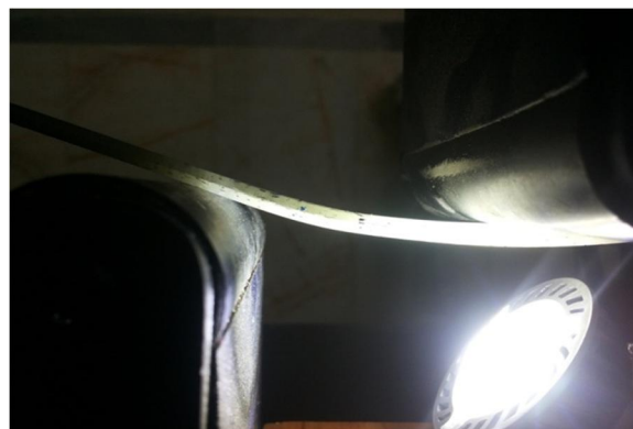
شکل 6 تعیین محل نوک ترک با روش نورپردازی
