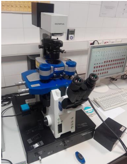
شکل ۷) میکروسکوپ نیروی اتمی 2 NanoWizard JPK Instruments برای آزمون تیرک در محیط آب
