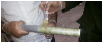
شکل ۶ پیچش باندهای پارچه‌ای بر روی لوله‌های آلومینیومی.
