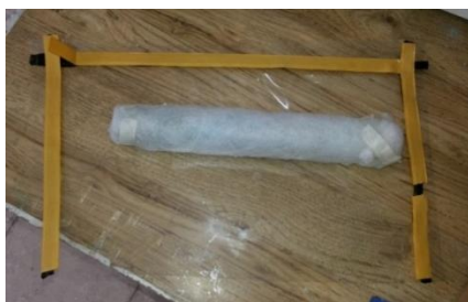
شکل ۸ وضعیت قرارگرفتن نمد جذب رزین.
