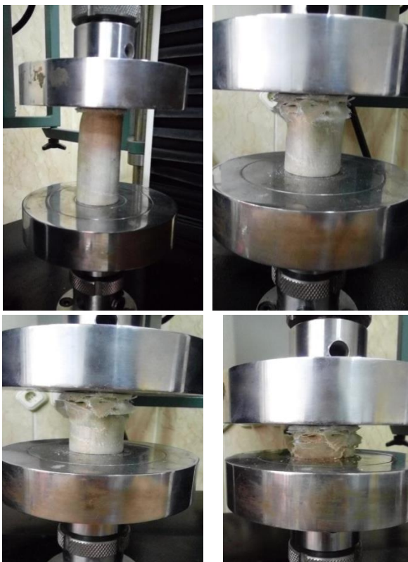
شکل ۱۱) نمونه ترکیبی آلومینیوم/کامپوزیت تحت بارگذاری فشاری شبه‌استاتیکی.
