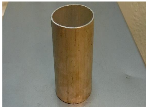
شکل ۱ پروفیل استوانه‌ای آلومینیومی استفاده شده در آزمایش‌ها.
