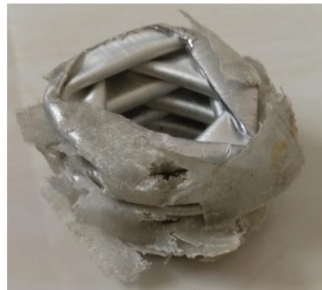
شکل ۲۱) نمونه ترکیبی آلومینیوم/کامپوزیت با دو لایه کامپوزیت بعد از اعمال بارگذاری.
