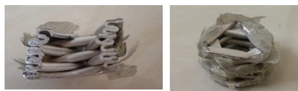
شکل ۱۸) نمونه ترکیبی آلومینیوم/کامپوزیت با درصد هم پوشانی ۵۰ درصد بعد از اعمال بارگذاری.
