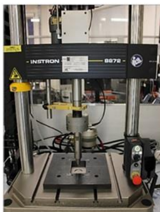
شکل ۵) نما و شماتیکی از تجهیزات آزمایش نفوذ شبه استاتیک و نحوه قرارگیری نمونه و حسگرهای نشر آوایی
