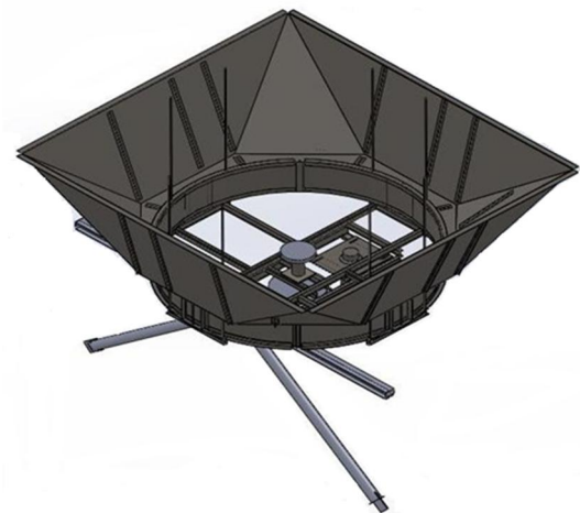
شکل 7 کانال هوایی به همراه سازه فن
