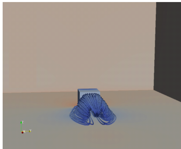
شکل ۱۳ نمایش گردابه پشت ساختمان با استفاده از مدل DES که از ترکیب دو گردابه متقارن با یکدیگر تشکیل شده است
