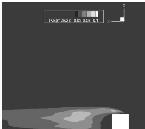
شکل ۱۵ مقدار انرژی توربولانسی در صفحه y = 5.5 با استفاده از مدل DES
