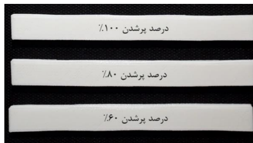
شکل ۱) نمونه‌های چاپی فوم شده با درصدهای پر شدن مختلف
