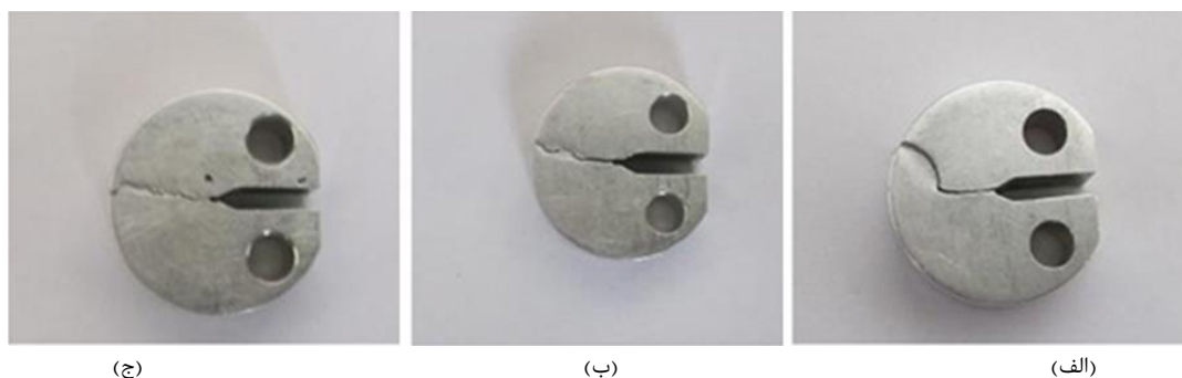
شکل ۱۸ مسیر رشد ترک ، الف: حالت معمولی ، ب: پاس ۲ ، ج: پاس ۴
