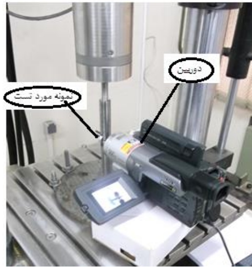
شکل ۱۰) نمایی از تصویر برداری رشد ترک در حین تست
