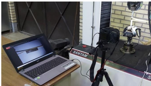
شکل ۲) چیدمان انجام تست چقرمگی شکست بین لایه‌ای مود I
