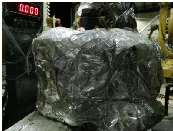
شکل ۳) مخزن بخار گازوئیل بر روی ترازو
