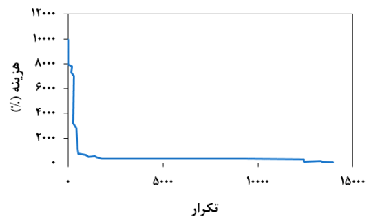
شکل ۱۰) نمودار تابع هزینه و حداقل شدن آن برای محاسبه ضرایب وزنی شبکه عصبی تخمین زننده F
