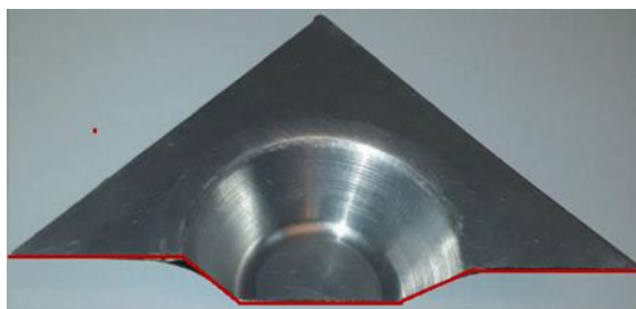
شکل ۵) مسیر اندازه‌گیری ضخامت در نمونه برش خورده در حالت AS
