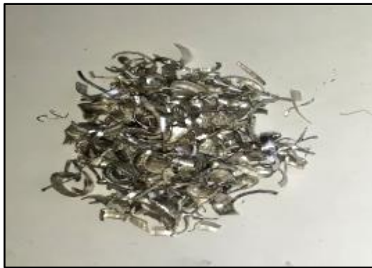
شکل ۱) براده‌های ماشینکاری شده آلیاژ Al6063
