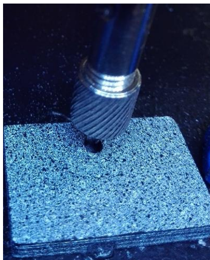
شکل ۶) عملیات سوراخکاری روی نمونه ی چاپ شده
