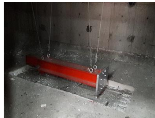
شکل ۱) تصویر طرح‌واره و واقعی سامانه آونگ بالستیک در آزمایشگاه ضربه و انفجار گیلان
