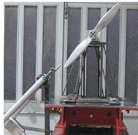
ب- مجموعه استند آزمایش، ملخ QP56 و تجهیزات جانبی
