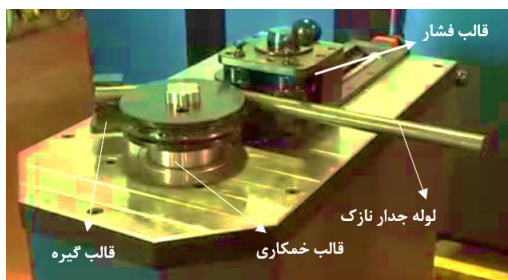
شکل ۱) دستگاه و تجهیزات خمش لوله مورد استفاده در این پژوهش
