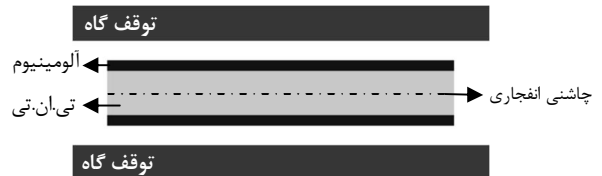
شکل 4 شماتیک چیدمان آزمایش استوانه و مکان مربوط به نقاط دتونیشن به همراه نمودار مربوط به شرایط مرزی مورد استفاده در تحقیق
