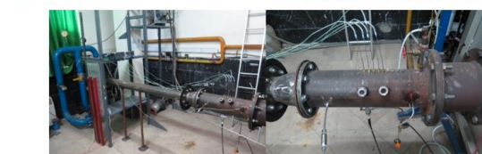
شکل ۶) شماتیک آزمونگر اتمسفریک، دمنده سانتریفیوژ، آزمونگر محفظه احتراق و مقطع آزمون به همراه ترموکوپل‌های مربوطه
