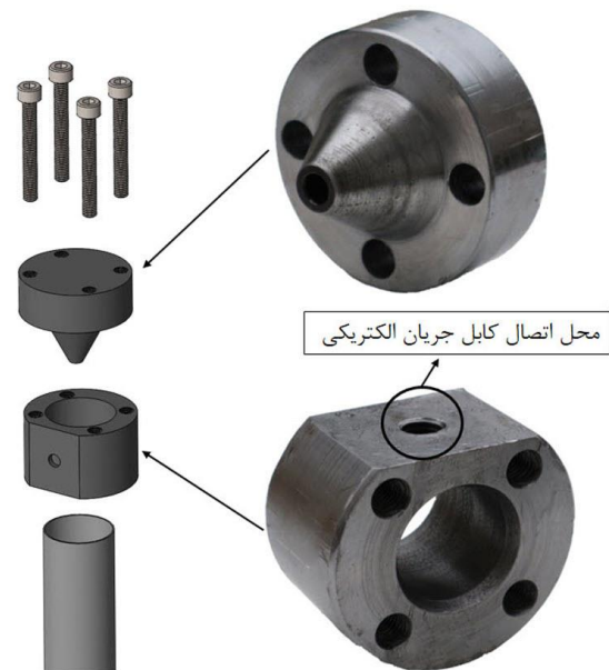
شکل ۲ قالب‌های رابط برای اتصال دستگاه مقاومتی به لوله و نگهداری ساچمه‌های فلزی
