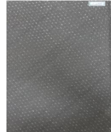
شکل ۱) نمونه صفحه کربن / اپوکسی ساخته شده به روش تزریق رزین در خلا
