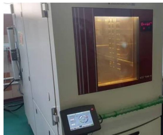
شکل ۵) آون جهت اعمال چرخه حرارتی به نمونه‌ها
