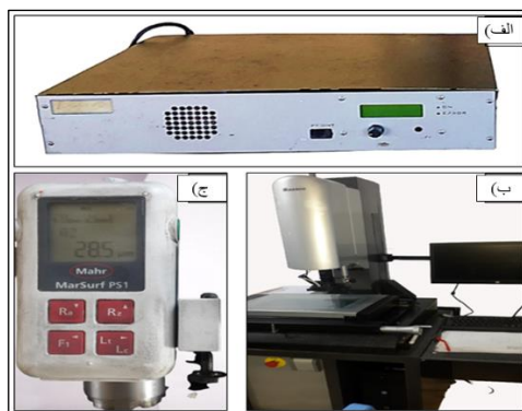
شکل ۲) تجهیزات مورد استفاده در آزمایش‌ها (الف) ژنراتور التراسونیک (ب) دستگاه تصویربرداری ویدئویی (ج) دستگاه زبری سنج
