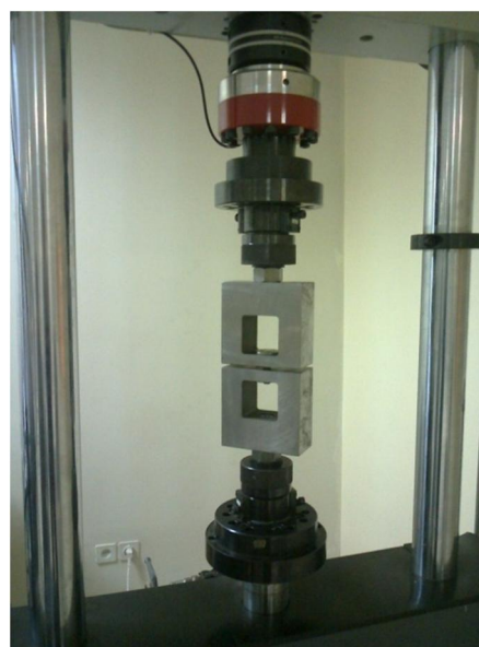
شکل 5 دستگاه آزمایش خستگی
