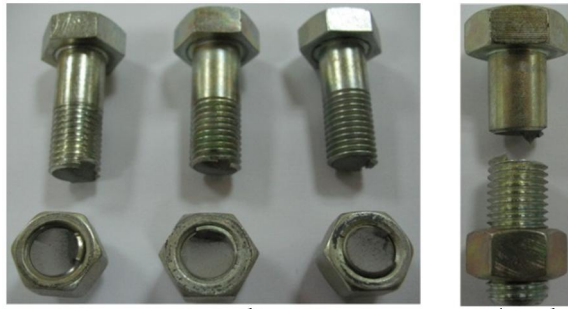
شکل 6 نمونه‌های پیچ M12 پس از شکست
