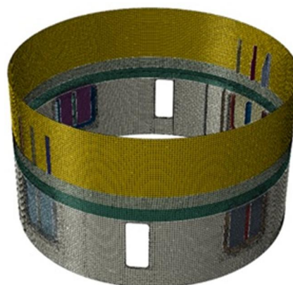
شکل 8 نمای مش بندی شده پوسته تقویت شده
